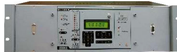
SNA 50-2R (SNA 50-2 format RACK 19" 3U) SNA 50-2 Live : Régulateur pour salle de spectacle
